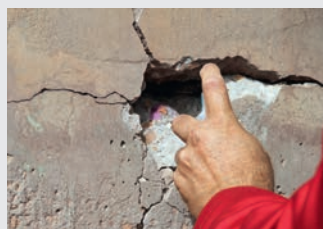
Fiche 6.04 Détermination de la profondeur de carbonatation
