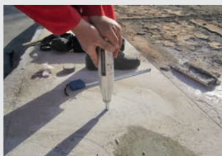
Fiche 6.05 Mesure de dureté superficielle au scléromètre
