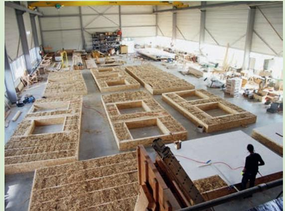
**Photo 11.7 L'isolation est faite de paille (360 mm) et de panneaux en fibres de bois de 40 mm d'épaisseur pour recouvrir les caissons montés en usine**
