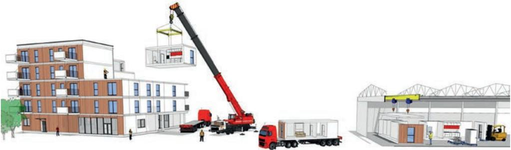
Illustration d'un cycle de construction modulaire, de l'usine au chantier
