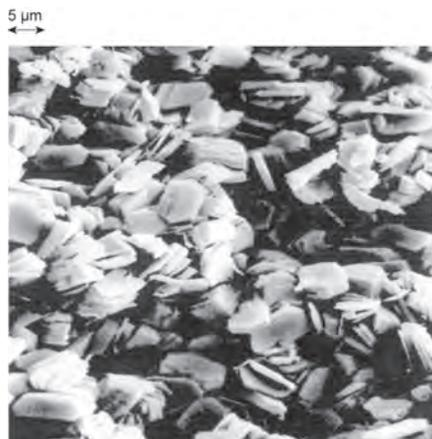
**Photo 1.3. Cliché de la microstructure du kaolin d'Arvor**
