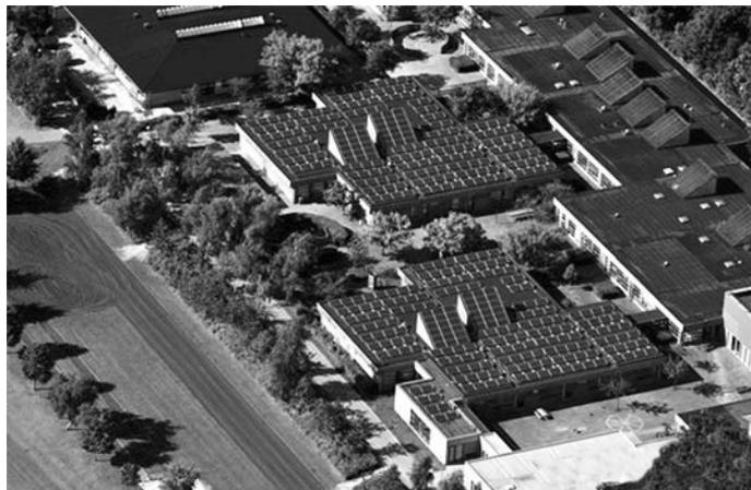
**Photo 15.1. École Balsmose : 706 m<sup>2</sup>, 105 kWc, 103 MWh (source : commune d'Egedal)**
