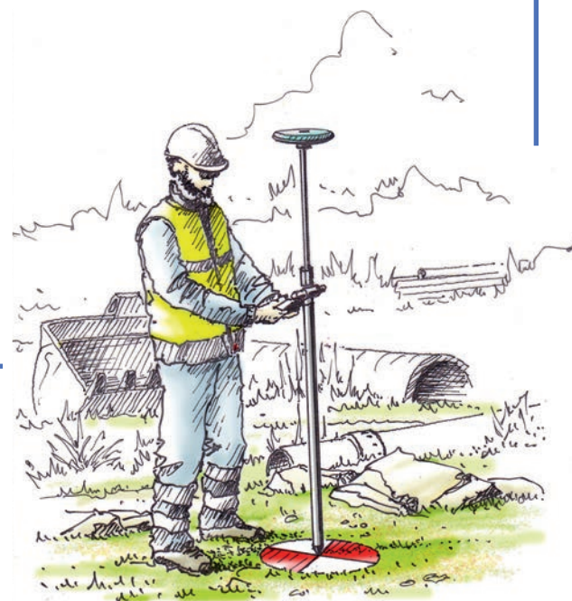
294 Pose et géoréférencement d'une cible. Cible au sol, opérateur avec canne GPS
